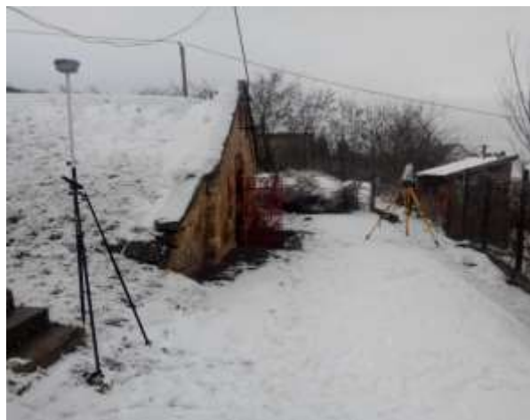
Ellenőrző illesztőpont mérés (GNSS), illetve állószkennelés
